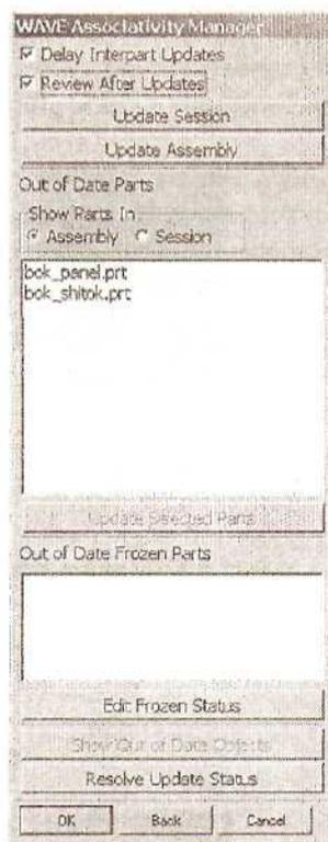
Рис. 5.35. Включение режима просмотра сборки после обновления
